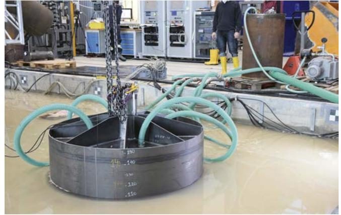
**Bild 5** Installation eines Suction Buckets mit  $D = 1,6$  m und  $L = 1,42$  m in der Grundbauversuchsgrube des TTH
